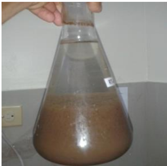
Figura 1. Modelo de reactor de laboratorio con 80% de agua residual y 20% de lodo activo nativo para el experimento de tratamiento biológico de aguas residuales.
